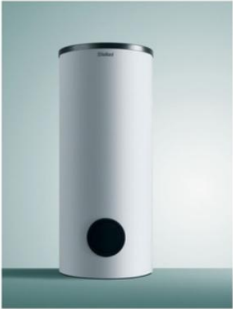
Depósito acumulador de ACS con capacidad de 200 litros y 1,81 m2 de superficie de intercambio. Clase energética C. Instalación en suelo.
