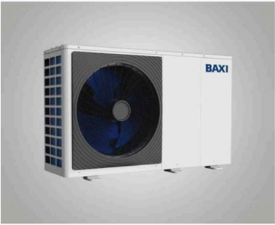
Bomba de calor Baxi PLATINUM BC Plus Monobloc 2 10 MR, unidad exterior monobloc, monofásica, potencia 10 kW, 8600 potencia frigorífica, COP 4,95, EER 4,55 y eficiencia energética A+++.
